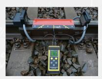
résistance effective du joint de rail isolant des charges parallèles. En complément à la mesure sans contact des tensions, la résistance du joint de rail isolant seul est déterminée. Plus de simulations possibles de joints de rail isolants défectueux.
