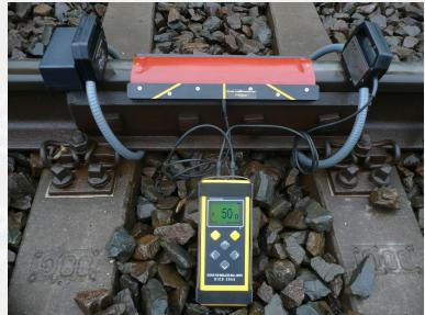
résistance effective du joint de rail isolant des charges parallèles. En complément à la mesure sans contact des tensions, la résistance du joint de rail isolant seul est déterminée. Plus de simulations possibles de joints de rail isolants défectueux.
