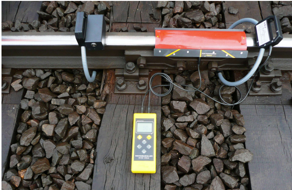
Fig. 3.6 Senseur C entoure le rail et joint isolant
