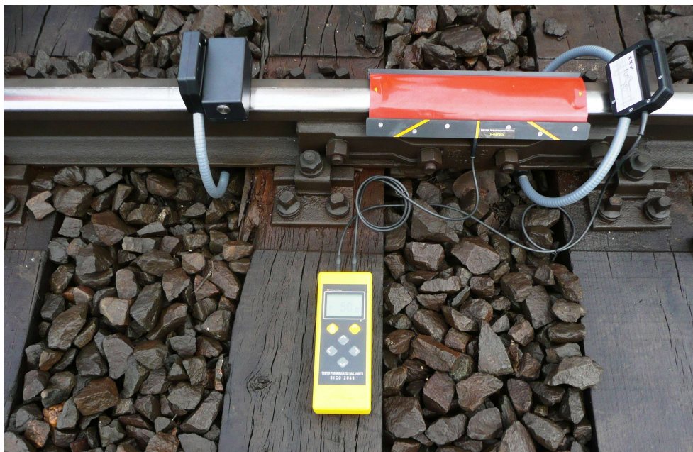
Fig. 3.8 Senseur C entoure le rail et joint isolant
