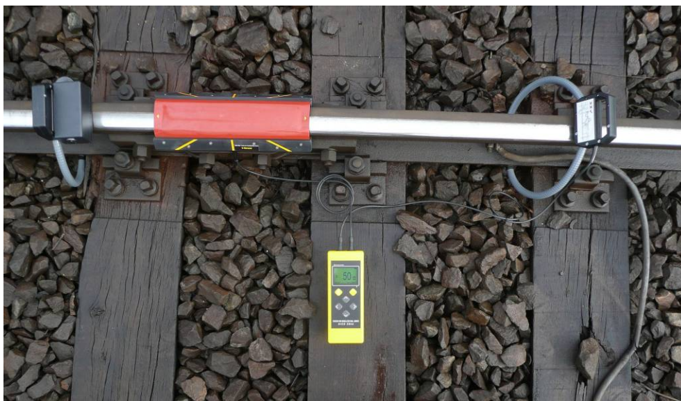
Fig. 3.7 Senseur C entoure le rail et un conducteur
