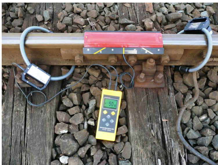
Fig. 3.1 Mise en place el SICO 2046
